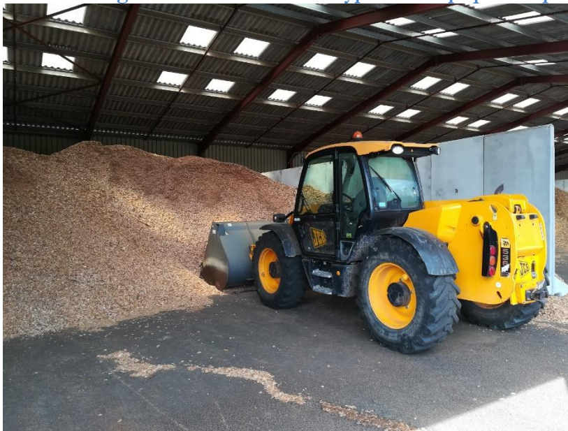
Photo 11 Engin de manutention de type télescopique sur plateforme
