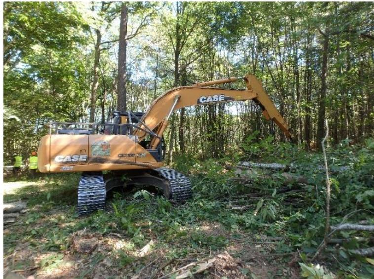
*Photo 6 Abattage façonnage mécanisé de taillis de Châtaignier par une machine non spécifique*
